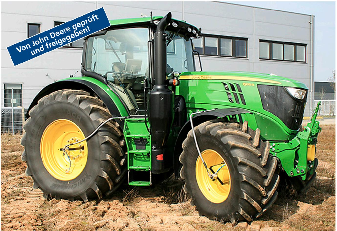
**AIRBOX/drive 2L mit ISOBUS-Steuerung**
