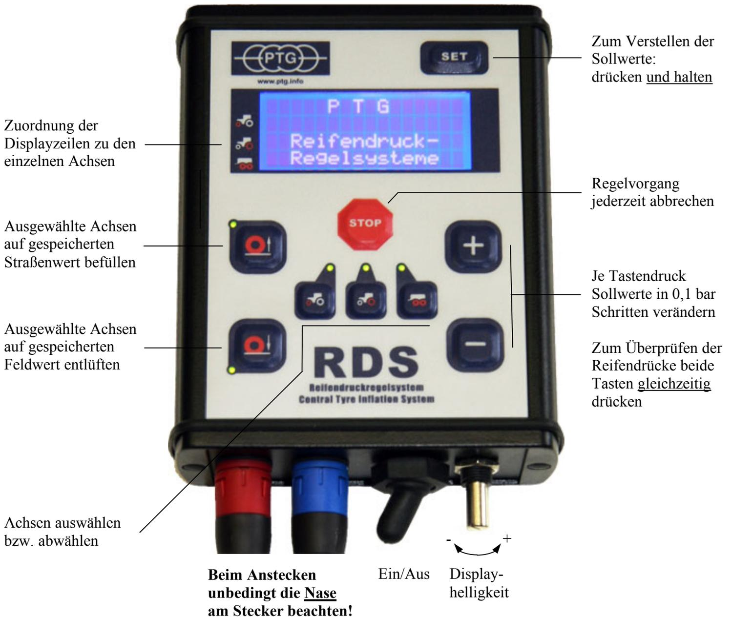
0. Der schwarze Knebelschalter an der Unterseite der Bedienkonsole dient als Hauptschalter für die Stromzufuhr des RDS, und steht i.d.R. in der Position EIN.
