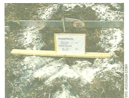
Bodenkontaktflächen: 1,6 bar Reifendruck links und 0,6 bar rechts. Mit niedrigem Reifendruck vergrößert sich die Bodenkontaktfläche. Die Folgen sind flachere Spuren und mehr Zugleistung.
