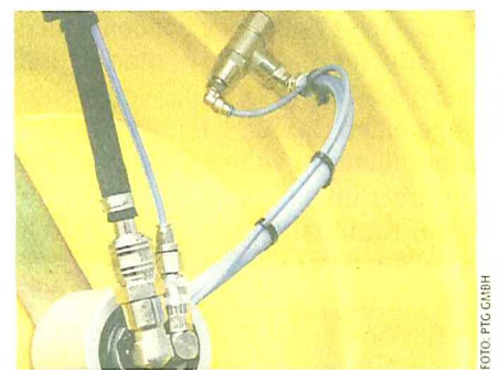
Schaltbares Radventil mit Rückschlagsicherung
