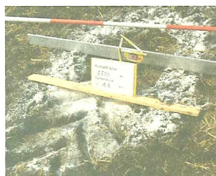
Bodenkontaktflächen: 1,6 bar Reifendruck links und 0,6 bar rechts. Mit niedrigem Reifendruck vergrößert sich die Bodenkontaktfläche. Die Folgen sind flachere Spuren und mehr Zugleistung.
