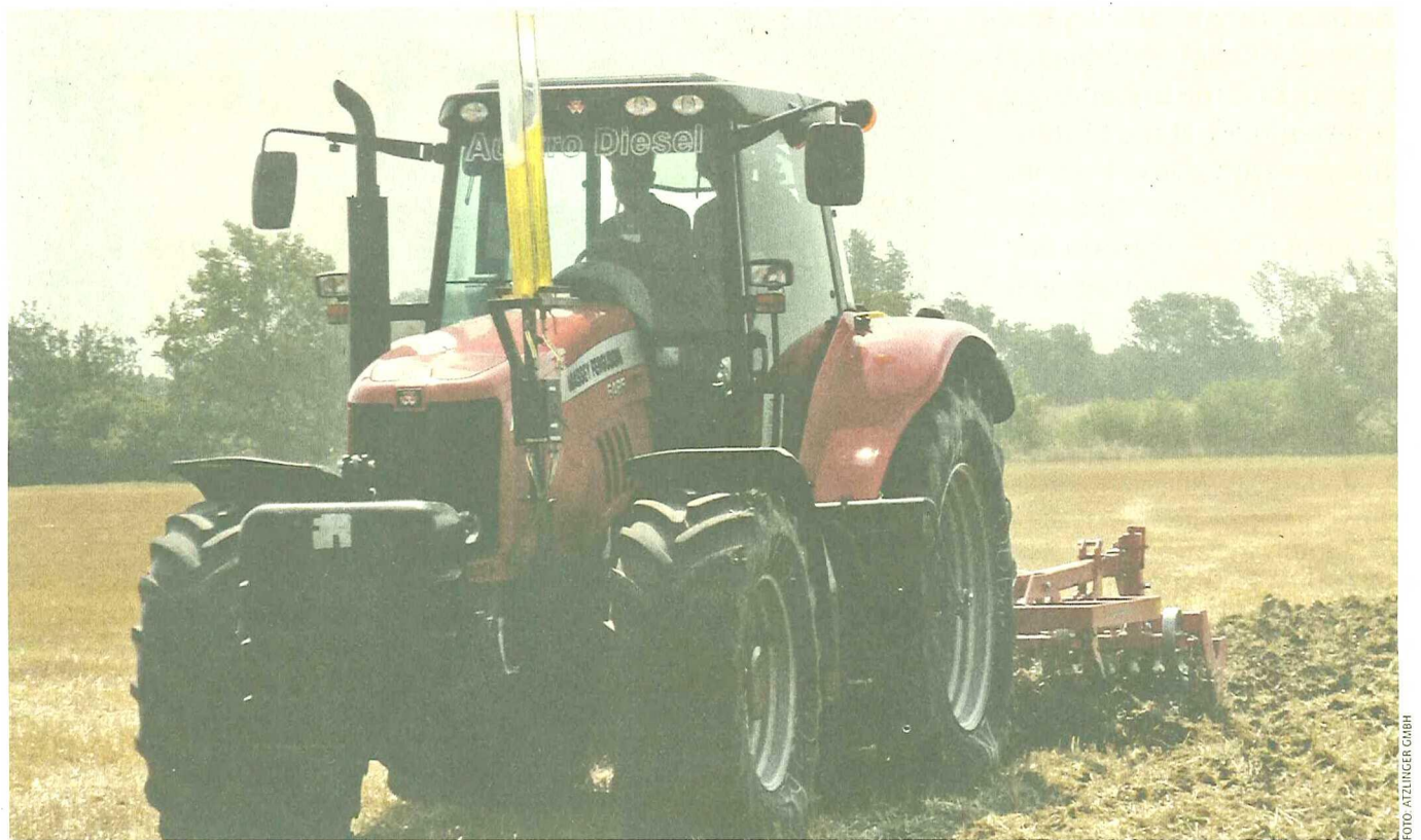
Beim Praxistest wurden Dieselsäulen aufgebaut, um den Einfluss der unterschiedlichen Reifendrücke auf den Verbrauch darzustellen.
